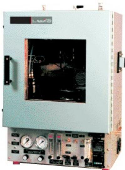
Analect RefinIR 100t с нагревателем для сбора результатов анализа проб тяжелых углеводородов при температуре до 100°C. Предусмотрено хранение до 12 проб жидких углеводородов объемом 40 мл каждая. Для проведения анализа используются датчики в искро- безопасном исполнении вместе с анализатором Diamond 20.
